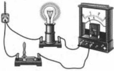
Согласно показаниям амперметра вычислите заряд, протекающий через лампу за 5 мин.
